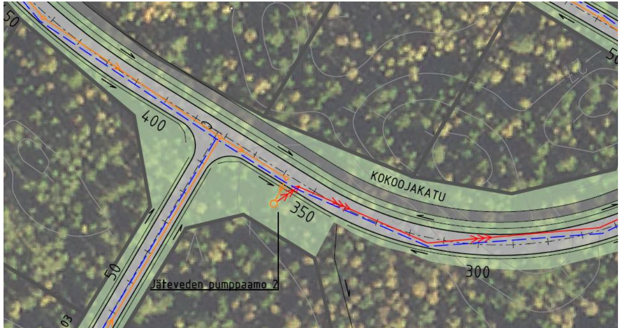
Kuva 20 Ote kunnallistekniikan alustavasta yleissuunnitelmasta.
